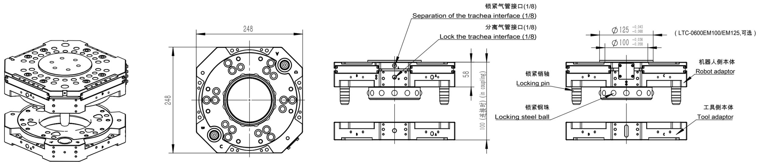
机器人侧可用连接孔及定位孔
