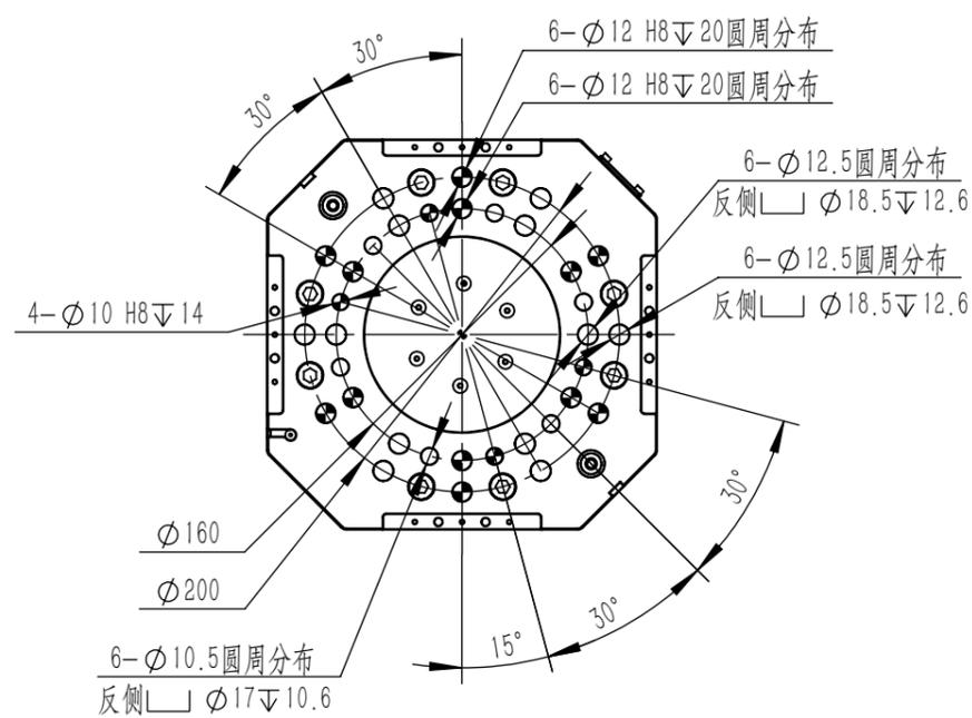
工具侧本体可用连接孔及定位孔
