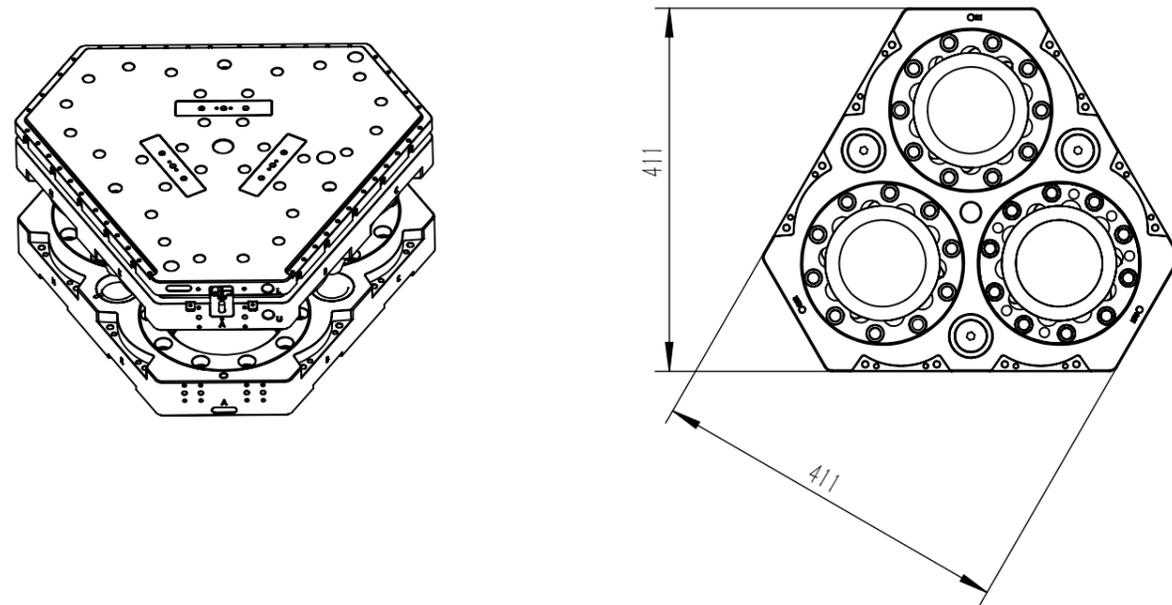
机器人侧可用连接孔及定位孔
