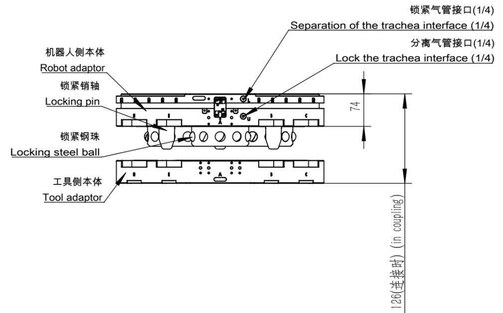
工具侧本体可用连接孔及定位孔
